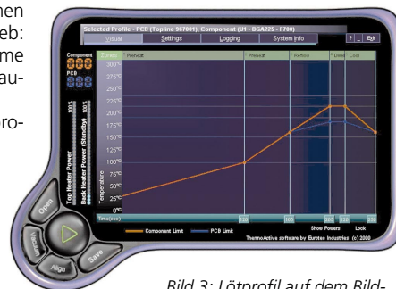
Bild 3: Lötprofil auf dem Bildschirm der PC-Steuerung
