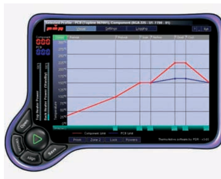
Bild 5. Die Bedienoberfläche des Reparatursystems beruht auf Windows. Mit ihr ist es auch möglich, Änderungen am Lötprofil durch Drag&Drop vorzunehmen
