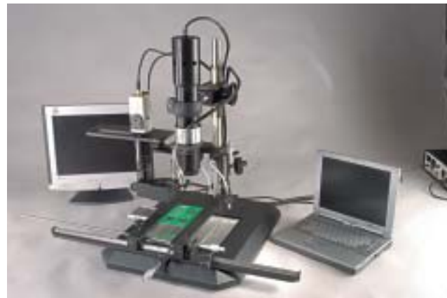
BGA/SMT-Reworksystem PDR-IR-X410 für prozesskontrollierte Nacharbeit
