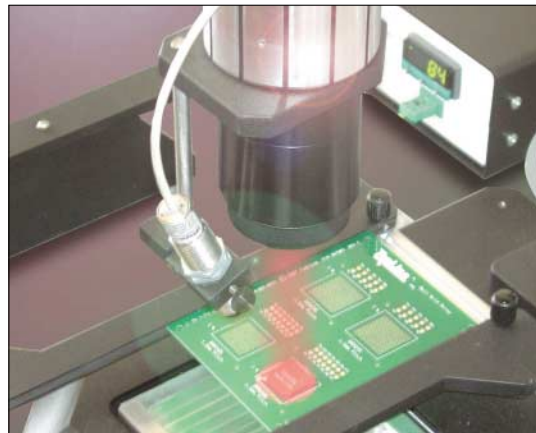
Bild 2: Der Fokussierte IR-Strahl erreicht jedes Bauelement auch bei tiefliegenden Bauteilen oder extrem enger Bestückung
